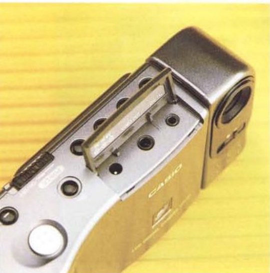
Sul lato superiore troviamo tutti i comandi dell'apparecchio e le interfacce analogica e digitale della fotocamera.
